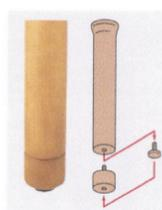
装着の際はMB脚のアジャスターをジョイントパーツに付け替えてご使用ください。（左図参照）
